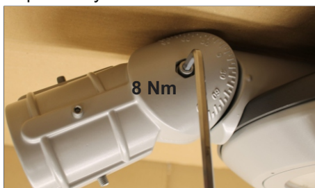
10. Povoláním aretačního šroubu lze nastavit požadovaný úhel vyzařování svítidla.
