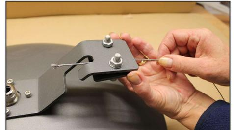
4. Die Schrauben des Montagebügels anziehen. Empfohlener Drehmoment 8Nm.
